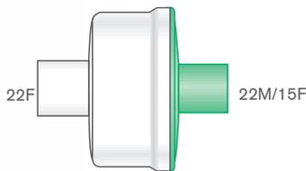
Air-Guard est un filtre hydrophobe à membrane plissée conçu pour la protection machine des équipements respiratoires et des concentrateurs d'oxygène.
